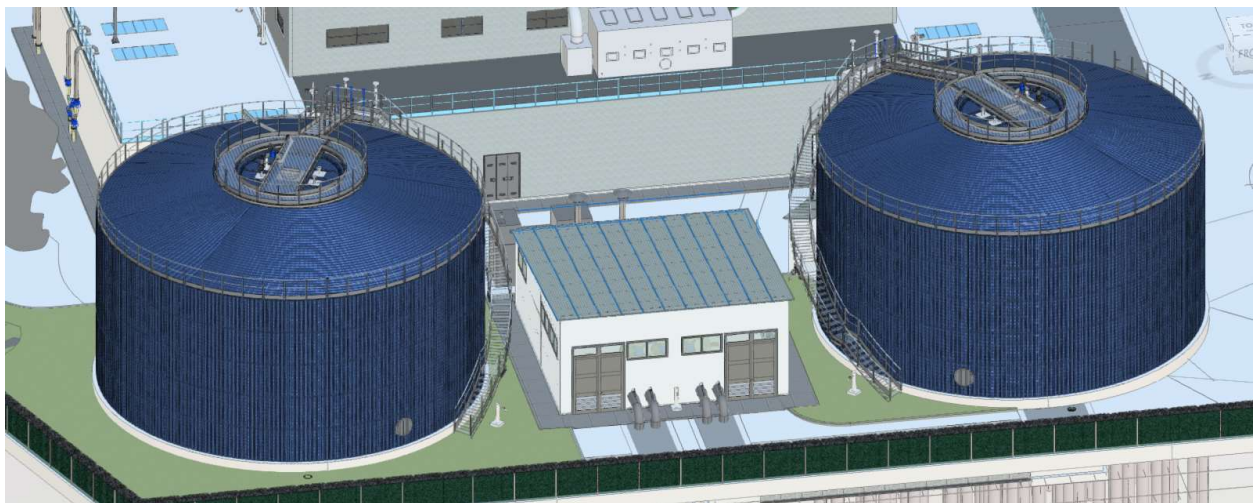
Figura 11: Vista 3D del comparto di digestione anaerobica dei fanghi, comprensivo del locale di miscelazione e riscaldamento fanghi
